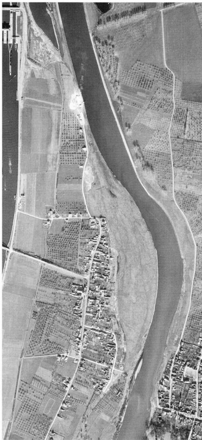
FIGUUR 8. Tussen 1956 (zie figuur 7) en 1965 werd de Maas ter hoogte van de Eijsder Beemden van een nieuwe oever voorzien. De oude grindbanken en de negentiende eeuwse kribben verdwenen.
